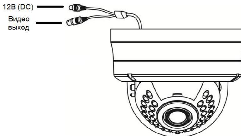
Рис.3.2.1. Подключение питания видеокамеры LTV-CDH-720L-V2.8-12
