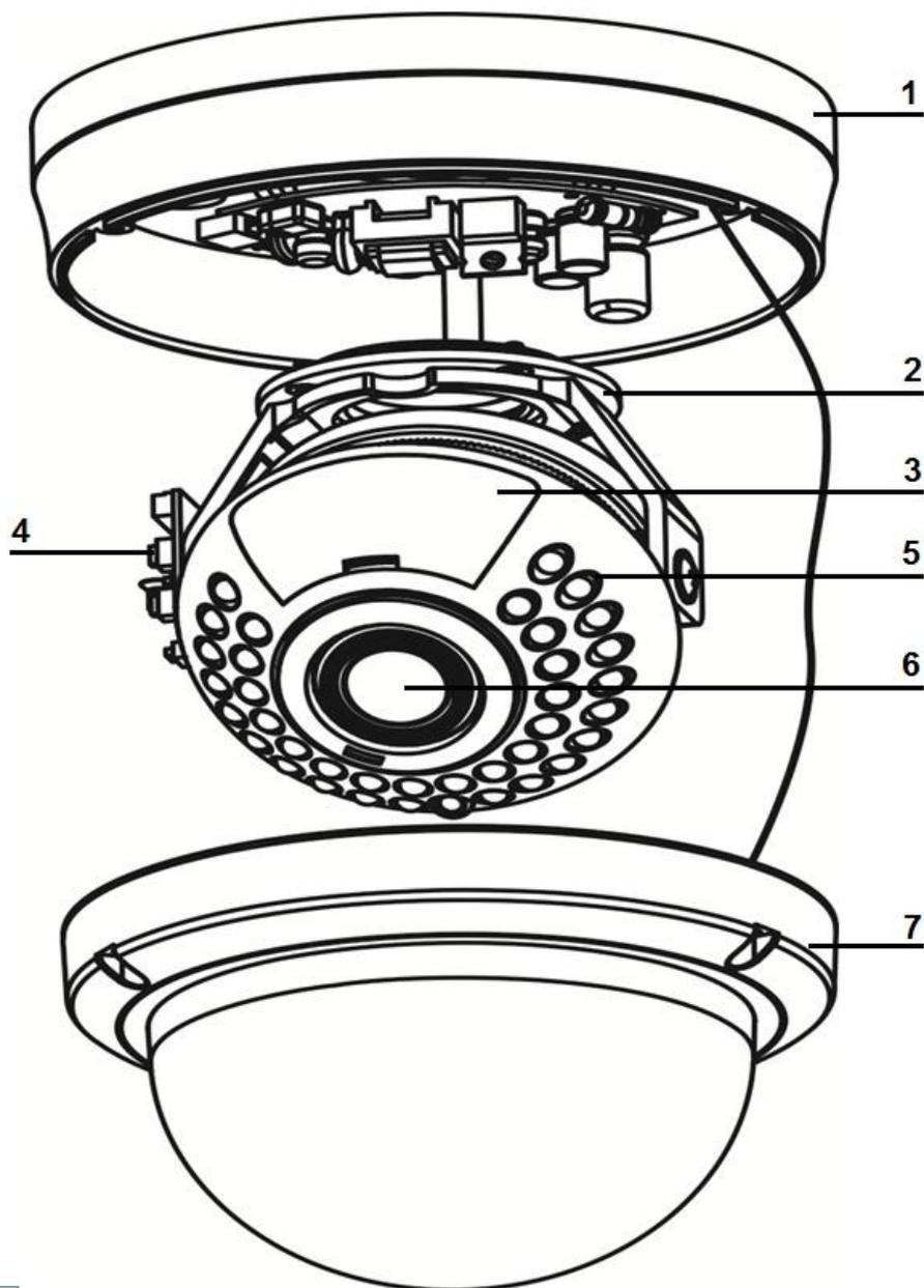
Рис.1.2.1. Описание видеокамеры LTV-CDH-720L-V2.8-12
