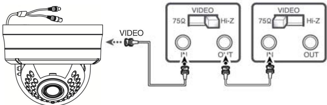
Рис.3.1.2. Подключение видеокамеры LTV-CDH-720-V2.8-12 к монитору
