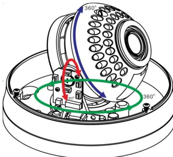
Рис.1.3.1. Настройка положения видеомодуля LTV-CDH-720L-V2.8-12
