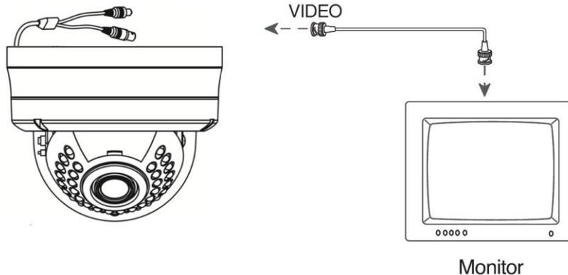
Рис.3.1.1. Подключение видеокамеры LTV-CDH-720L-V2.8-12 к монитору
