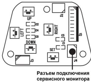
Настройка видеокамеры при помощи экранного (OSD) меню
