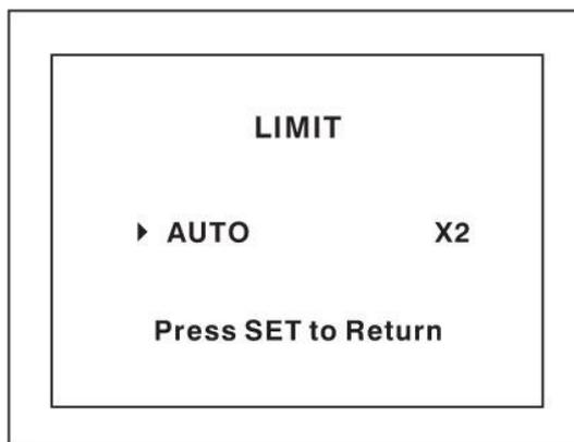
Когда интенсивность освещения недостаточна, то при включении этой функции камера распознает уровень освещенности и увеличивает чувствительность матрицы путем накопления заряда.
