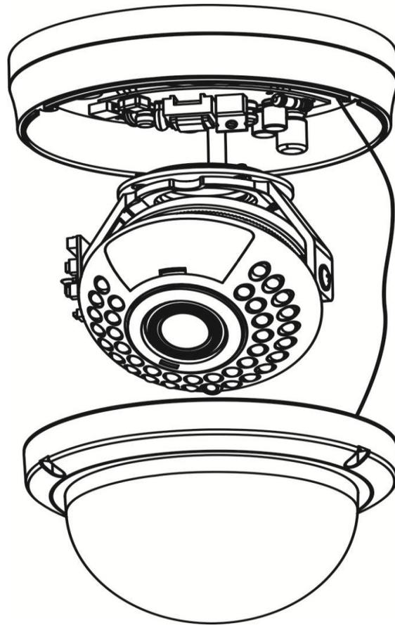
Рис.2.1.1. Монтаж видеокамеры на потолок / стену
